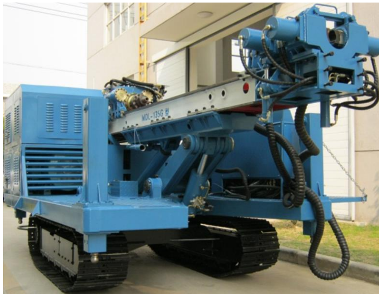
Figura 9. Máquina de perforación con anclaje [8]
