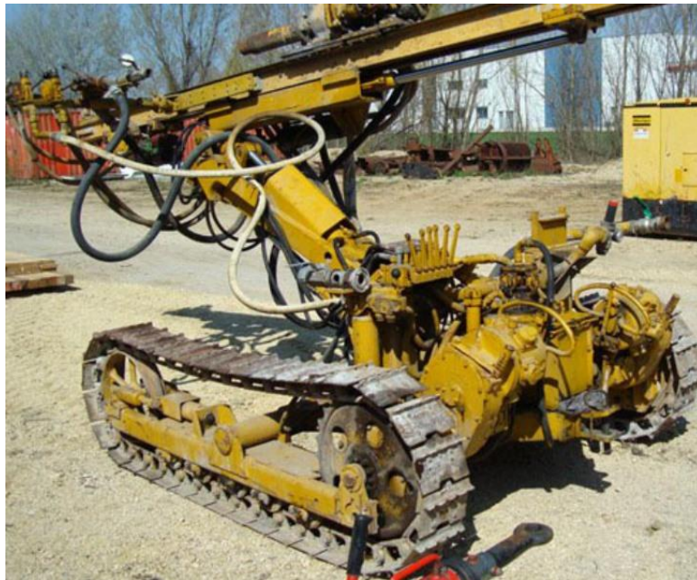
Figura 6. Oruga con Torre de perforación Neumática [6]
