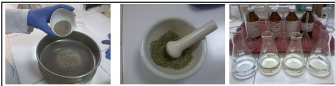
Gráfico 28: Preparación muestra cuantificación Arsénico, Proyecto práctica investigativa, Autores, 2013
