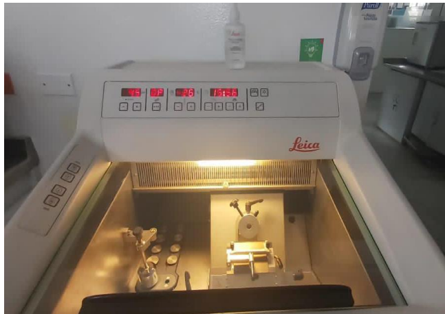
Figura 30. Criostato con mecanismo de avance digital, vista cámara fría (crio barra, pesas, soporte moldes).
