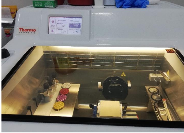
Figura 32. Criostato con mecanismo de avance digital, vista cámara fría (crio barra, pesas, soporte moldes).
