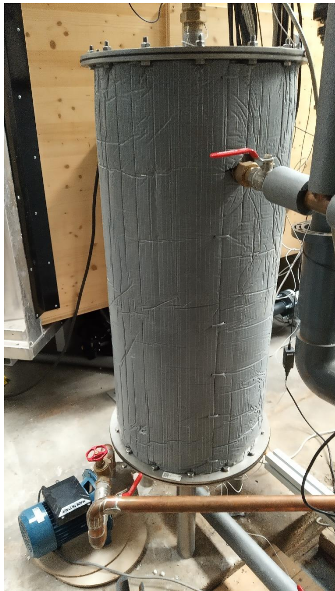
Obr. 15 Skutečný akumulátor postavený v prostorách laboratoře Ústavu mechaniky tekutin a termodynamiky
