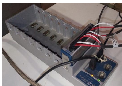
Obr. 34 Převodník s připojenými teploměry v základně
