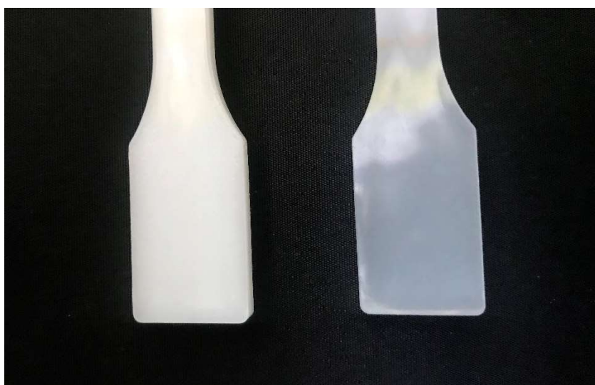
Obrázek 21 - Srovnání odlitku z Litenu (vlevo) a Mostenu (vpravo)
