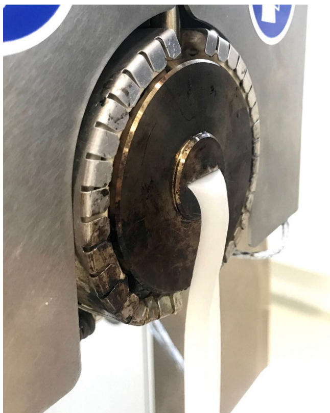
Obrázek 31 - Čelo s pohledem na větší a menší průměr reometrické hlavy
