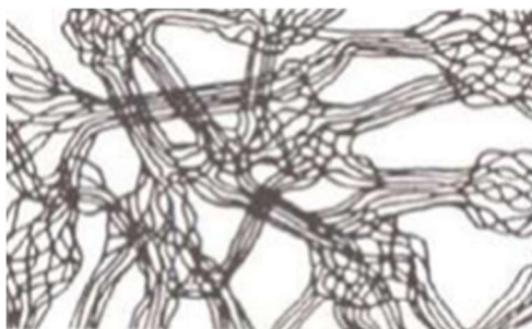
Obrázek 2 - Struktura semikrystalických termoplastů [4]
