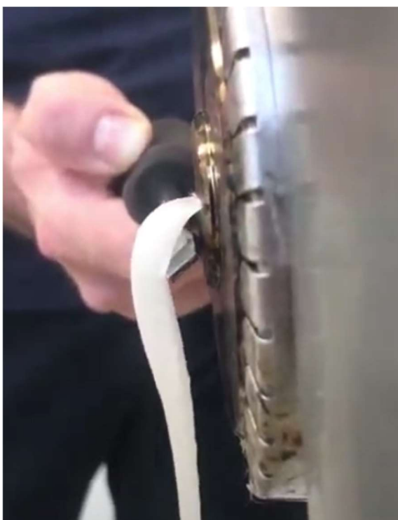
Obrázek 32 - Vliv magnetického konce šroubováku na vytékání taveniny
