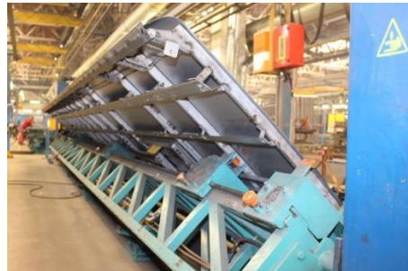
Obr. 38: Střešní kostra autobusu
