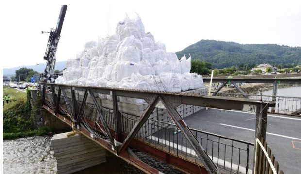
Obr. 270 Petrov zátěžová zkouška původní přímopásové nýtované konstrukce mostu vyrobeného v sobotínských železárnách z července 2019 zdroj: ČT 24
