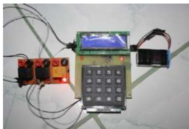
Gambar 9. Relay Dalam Keadaan Password Salah
