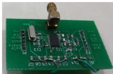
Gambar. 7 Hasil Implementasi Desain TTC dengan CC1000
