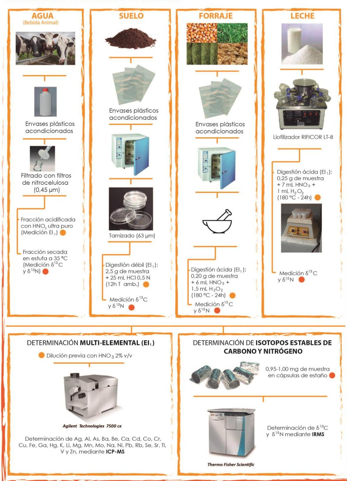
**Figura 1.2:** Recolección y procesado de muestras de agua, suelo, forraje y leche, para la medición de elementos inorgánicos (EI<sub>1</sub>) e isótopos estables.
