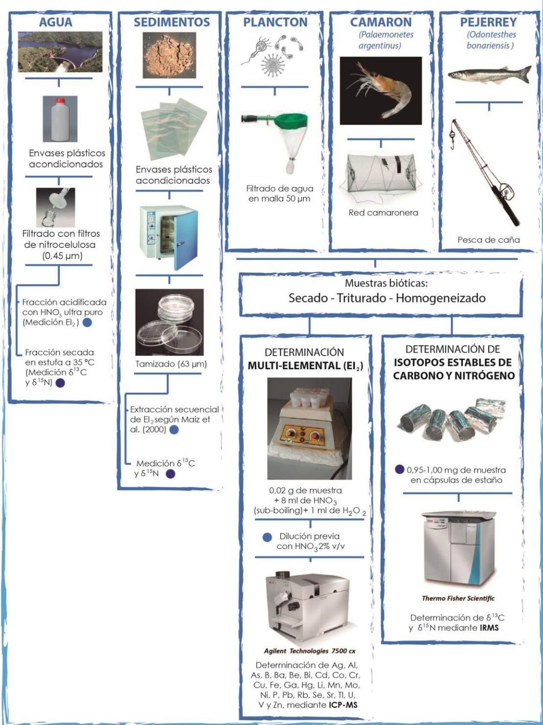
**Figura 2.11:** Recolección y procesado de muestras de agua, sedimento, plancton, camarón y pejerrey para la medición de EI<sub>2</sub> e isótopos estables.
