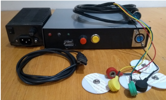
Figura 8. Fotografía del equipo prototipo desarrollo junto a los electrodos descartables utilizados.
