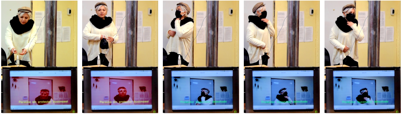
Fig. 7. Imágenes del sistema prototipo en funcionamiento. En la secuencia se observa una persona que ingresa al recinto sin protector buconasal, en el monitor del sistema se observa un sombreado en rojo sobre la imagen lo que indica que se detectó esta falta de uso. A partir de la tercera imagen la persona se coloca el protector buconasal, indicándose en el monitor del sistema con una leyenda en color verde.
