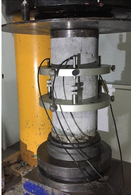
Figura 23 – Ensaio da determinação do módulo de elasticidade do betão.
