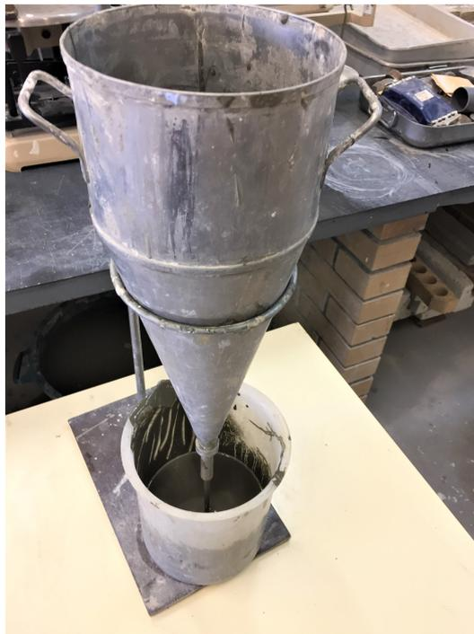
**Figura 8 – Ensaio do cone de Marsh.**
