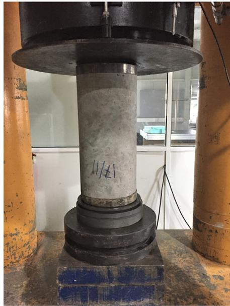
**Figura 20 – Ensaio de resistência à compressão axial em provete da composição 1.**
