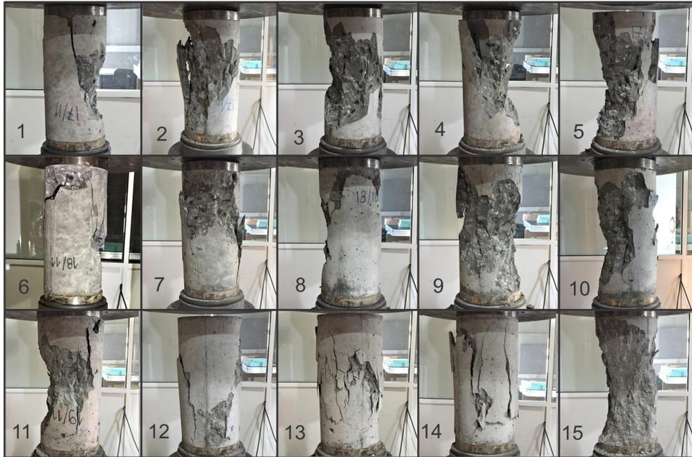
**Figura 30 – Rotura dos provetes à compressão**
