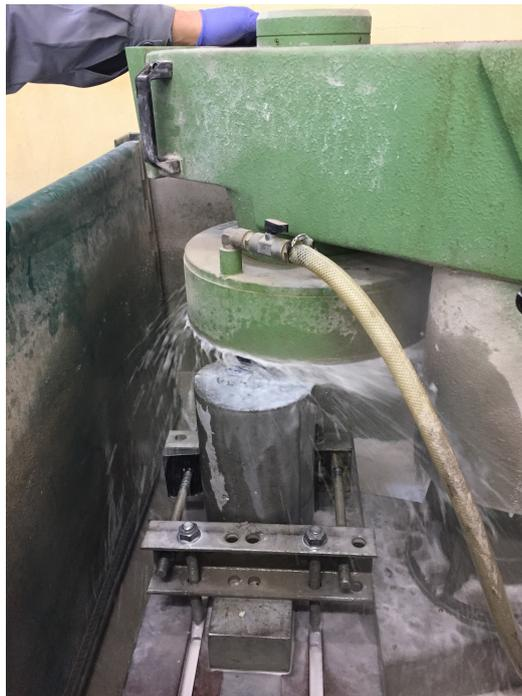
**Figura 18 – Retificação de provete**
