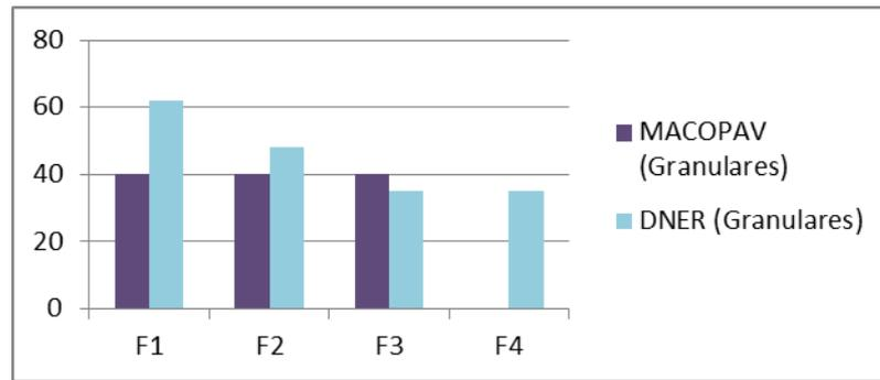
Figura 18: Resultantes das camadas granulares para estrutura-tipo 2; tráfego T5;
