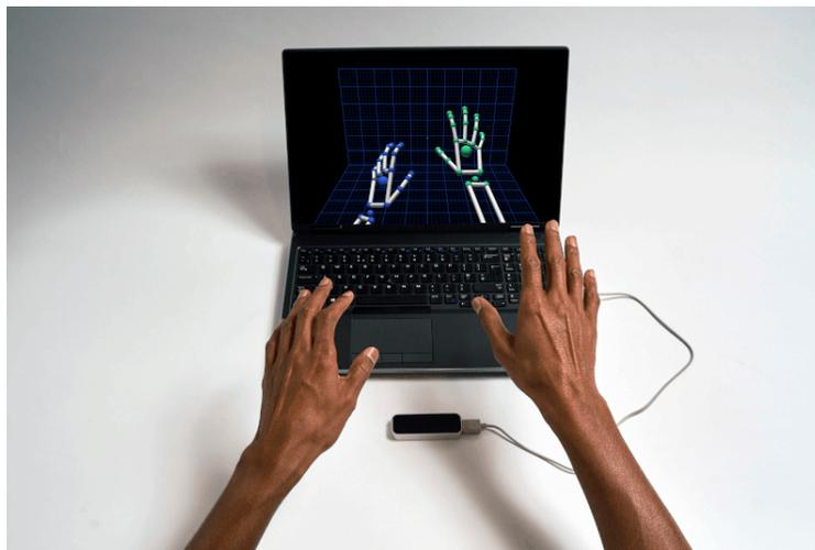
Figura 2.2: Leap Motion Controller em funcionamento [9].
