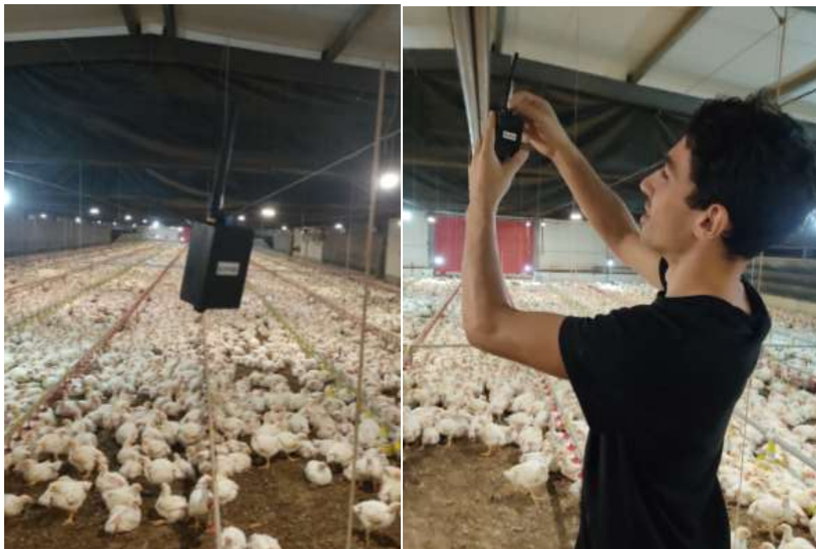
Figura 21 - Instalação dos endpoint's no aviário Dark House .
