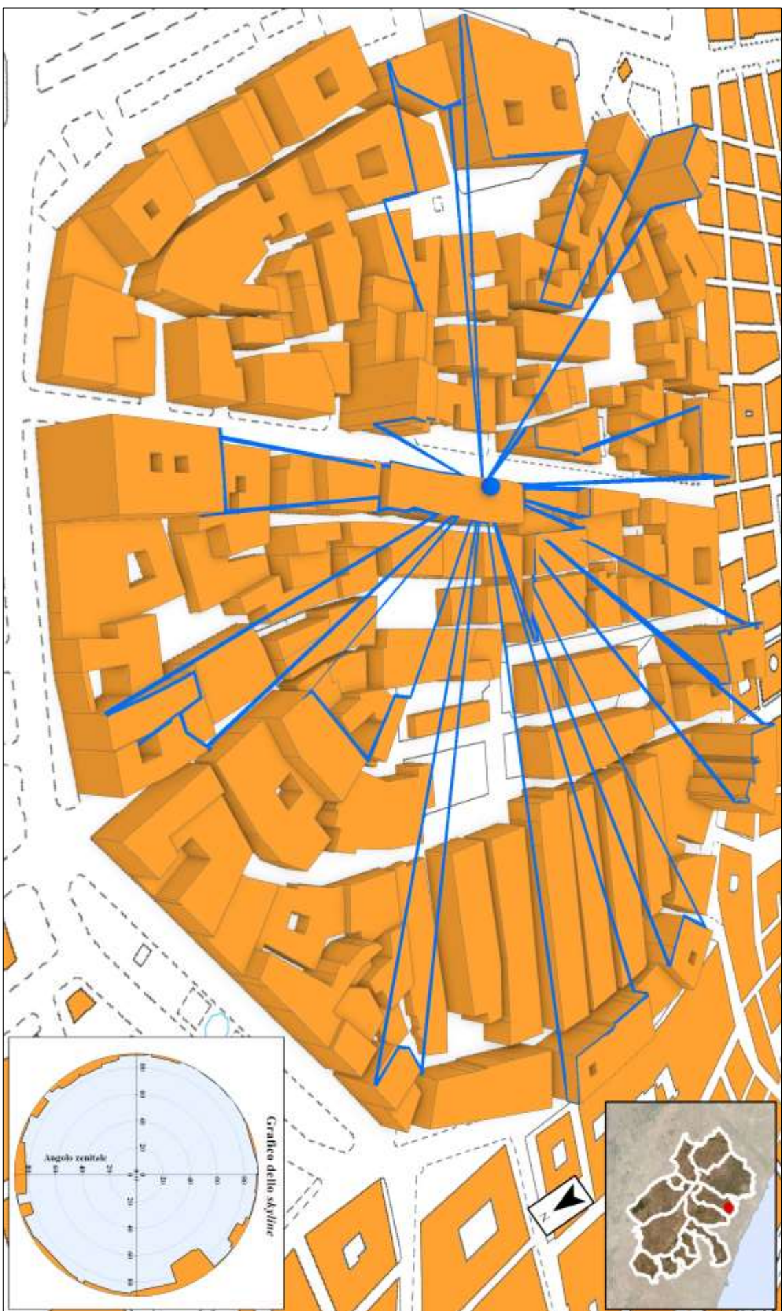
Figura 70 – Il centro storico di Corato visualizzato in una scena di ArcGIS Pro , dove i poligoni in 3D degli edifici della parte storica si sovrappongono alla basemap della CTR. In blu la polilinea dello skyline cittadino derivato dalla posizione della sfera, di cui si riporta il profilo nel grafico a margine. Elaborazione dell'autore su dati: ESRI, ISTAT, Regione Puglia.
