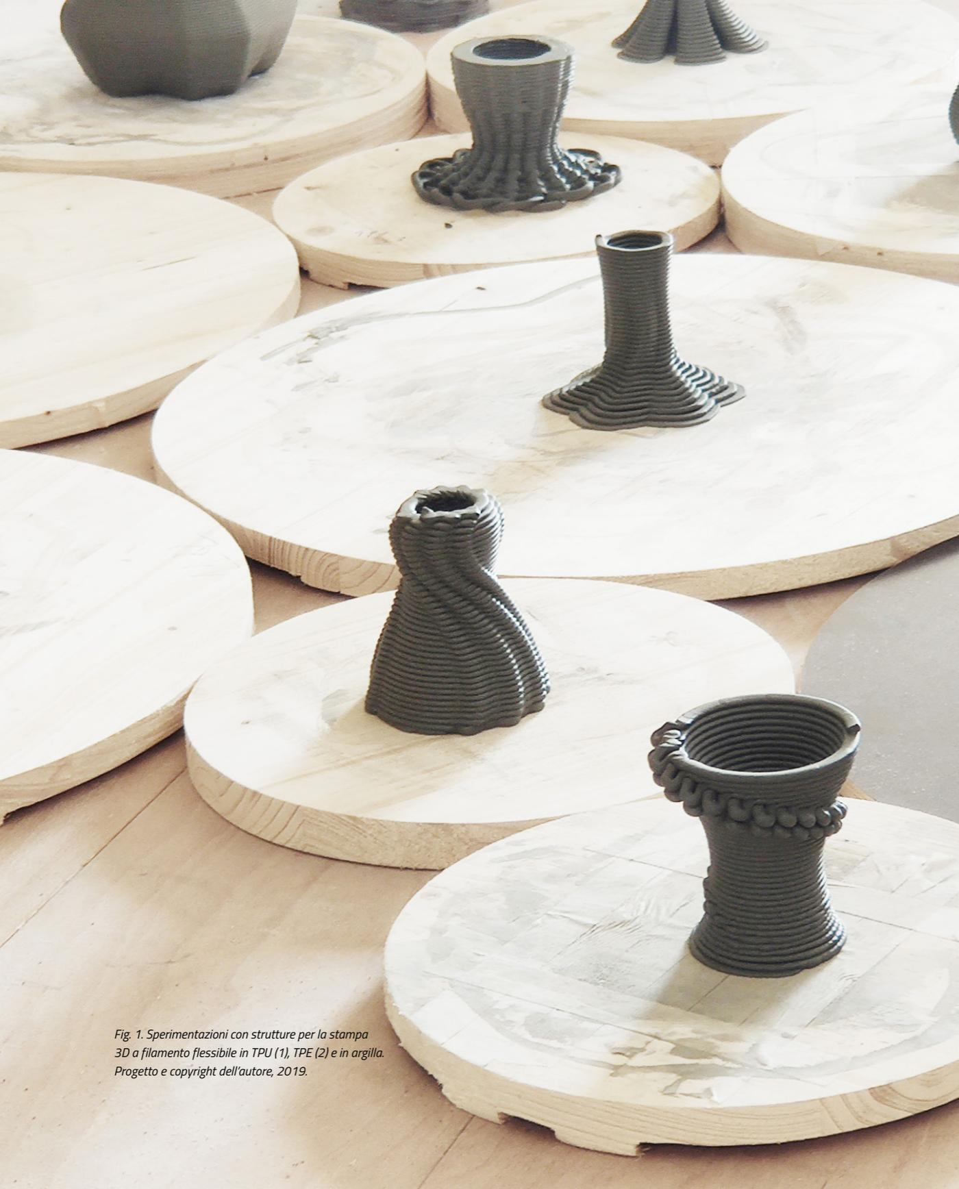
Fig. 1. Sperimentazioni con strutture per la stampa 3D a filamento flessibile in TPU (1), TPE (2) e in argilla. Progetto e copyright dell'autore, 2019.
