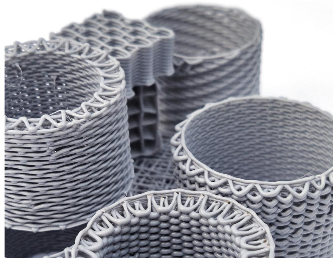
Fig. 2. Sperimentazioni con strutture per la stampa 3D a filamento flessibile in TPU (1), TPE (2) e in argilla. Progetto e copyright dell'autore, 2019.
