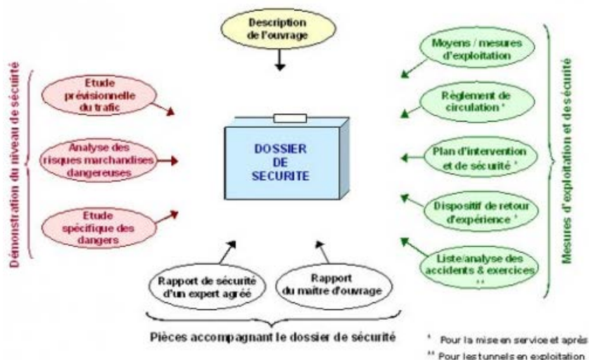
Figura 17: contenuto del dossier di sicurezza nelle previsioni normative francesi – gallerie superiori a 500 m di lunghezza e facenti parte del sistema di rete stradale TERN
