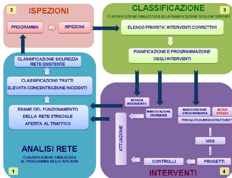
Figura 26: Ciclo complessivo delle attività di controllo e ispezione previsto dal D. Lgs. 35/2011 (ex Allegato "Linee guida in materia di gestione della sicurezza delle infrastrutture stradali" al DM 2/5/2012)
