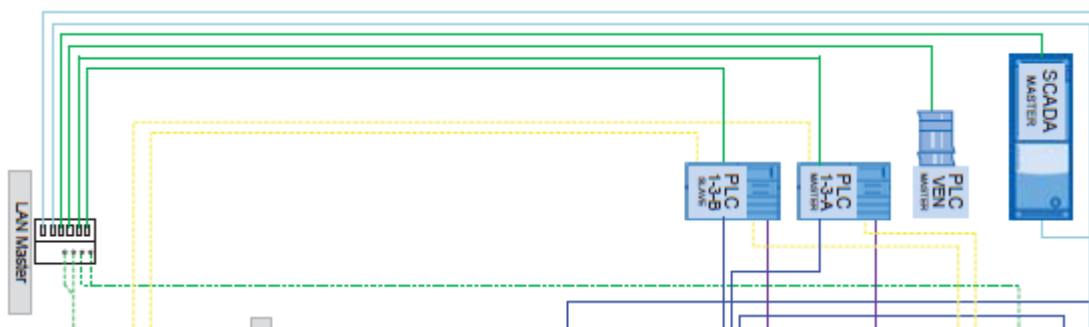
Figura 78: Collegamenti tra SCADA e PLC
