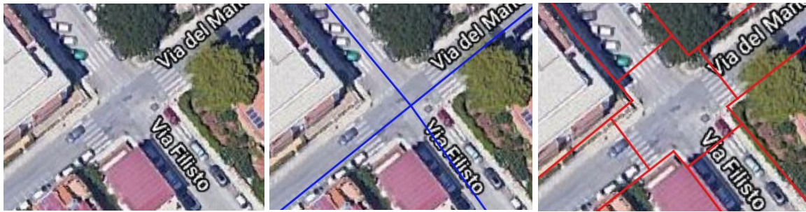
Figura 75. Differenza della modellazione di un incrocio nella rete stradale (blu) e nella rete pedonale (rosso).
