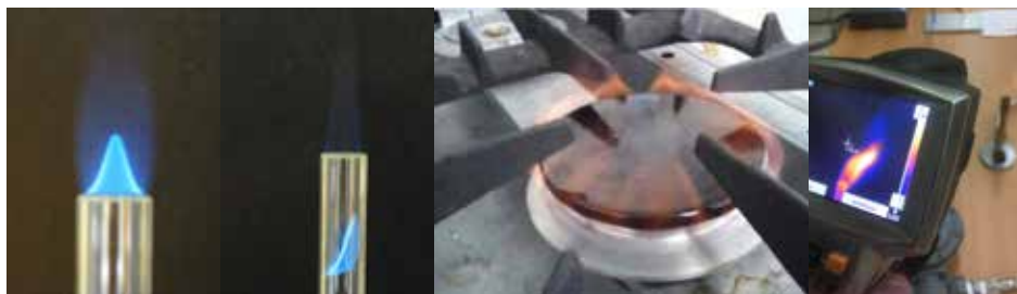
Figuur 4. Verbranding van waterstof: links: een vergelijking tussen een aardgasvlam (l), en een waterstofvlam (met vlaminslag); midden: gasstel op waterstof (Almaas Technologies); rechts: laboratoriumopstelling van (onzichtbare) waterstofvlam en detector
