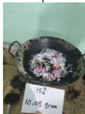
Pengujian Marshall “Pencampuran agregat, plastik, dan aspal”
