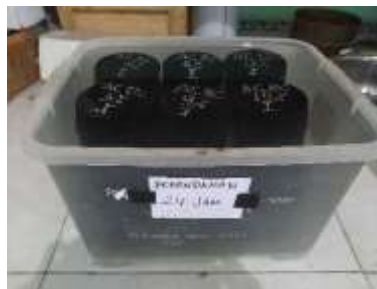
Gambar 3.33 Perendaman benda uji selama 24 jam
