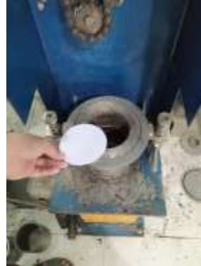
Gambar 3.26 Pelapisan kertas pada permukaan cetakan
