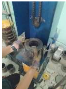
Gambar 3.25 Pemasangan cetakan pada alat mesin penumbuk
