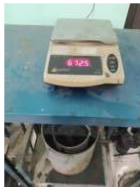
Gambar 3.34 Penimbangan benda uji dalam air
