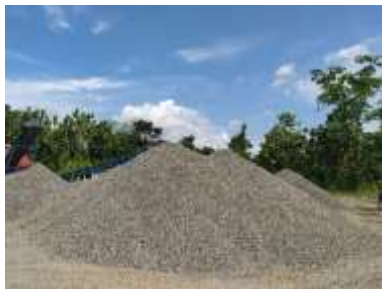
Persiapan bahan “Pengambilan sampel agregat kasar”
