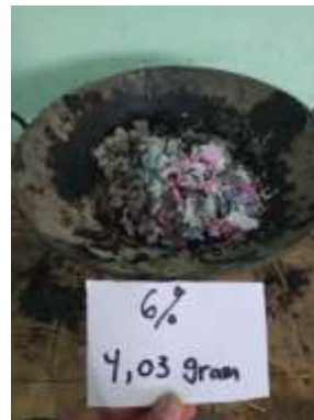
Gambar 2.21 Pencampuran limbah plastik kadar 6%
