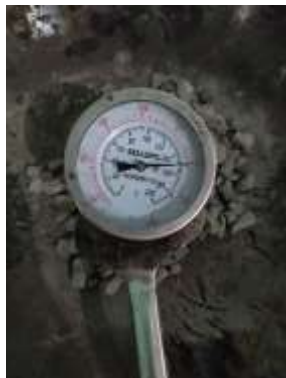
Pengujian Marshall “Pengukuran suhu agregat”
