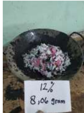
Gambar 3.23 Pencampuran limbah plastik kadar 12%
