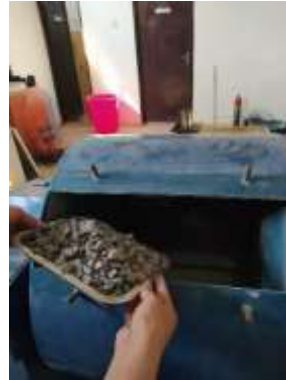
Pengujian keausan agregat “Pemasukan ke dalam mesin abrasi”
