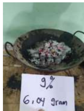
Gambar 2.22 Pencampuran limbah plastik kadar 9%
