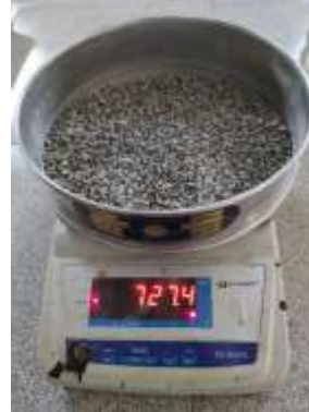
Pengujian analisis saringan “Penimbangan hasil saringan”
