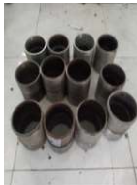
Gambar 3.13 Cetakan mold untuk benda uji
