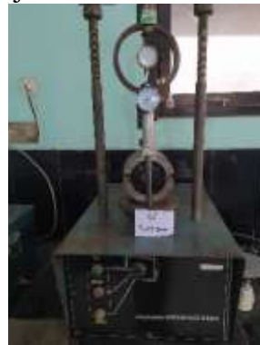
Pengujian Marshall “Pengujian memakai alat Marshall”
