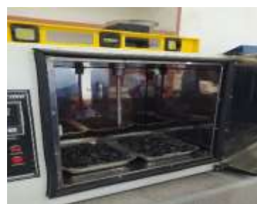
Pengujian keausan agregat “Pengeringan sampel agregat”
