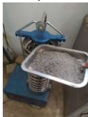
Pengujian analisis saringan “Pemasukan sampel ke dalam ayakan”
