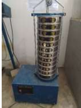
Pengujian analisis saringan “Penggetaran menggunakan mesin”
