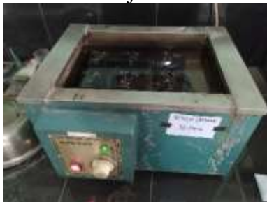
Pengujian Marshall “Perendaman 30 menit pada suhu 60 derajat C”
