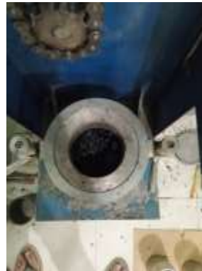
Gambar 3.27 Proses pemasukan campuran ke dalam cetakan
