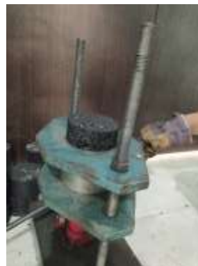
Gambar 3.29 Pengeluaran benda uji setelah 24 jam
