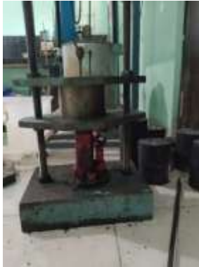
Gambar 3.5 Alat pengeluar benda uji
