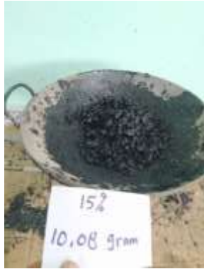
Pengujian Marshall “Pengadukan campuran sampai homogen”
