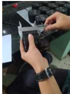
Gambar 3.31 Pengukuran tinggi benda uji
