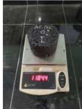
Gambar 3.35 Penimbangan benda uji pada kondisi SSD
