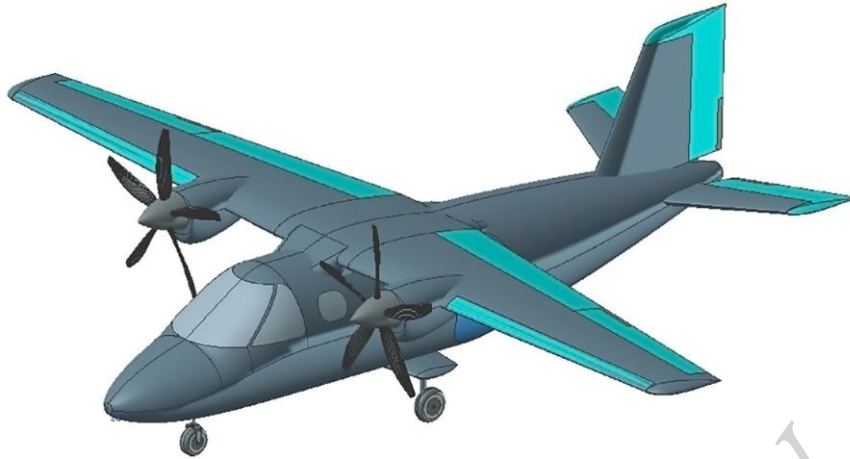
Рис. 8. Модель майстер-геометрії цивільного легкого літака
