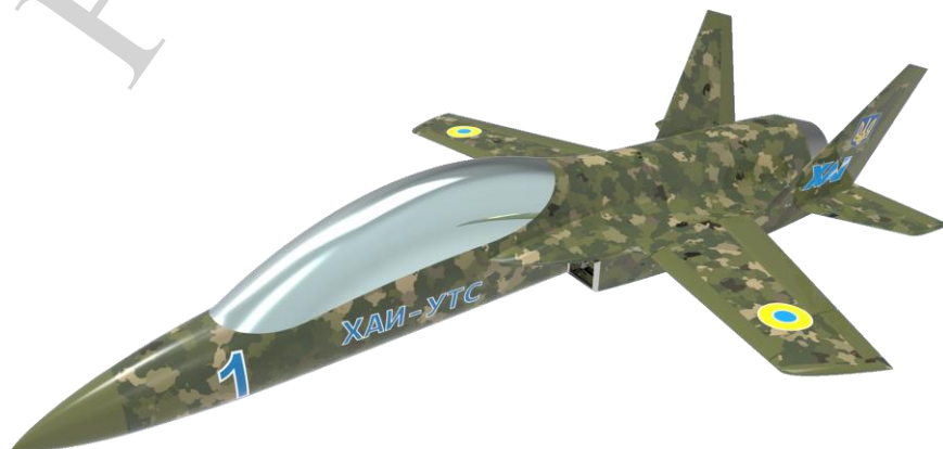
Рис. 3. Модель майстер-геометрії навчально-бойового літака
