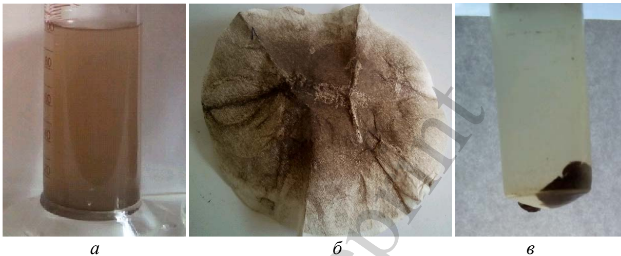
Рис. 4. Результати фільтрування та центрифугування проб стічної води: а – фільтрат; б – затриманий осад на фільтрувальному папері; в – осад після лабораторної центрифуги
