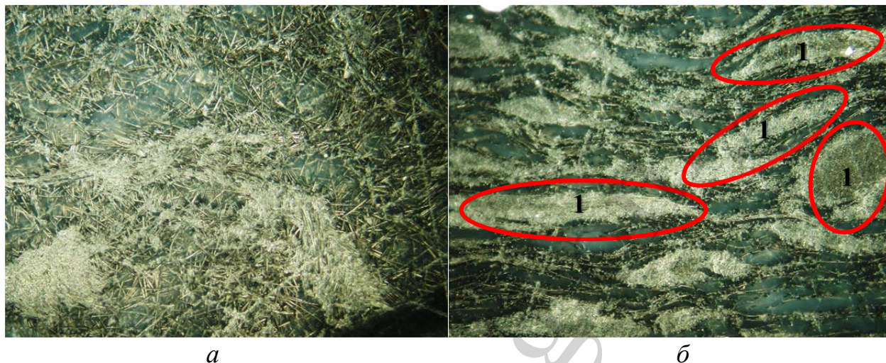
Рис. 5. Мікроструктура полімерно-композитних матеріалів на основі політетрафторетилену який містить 40 мас. % вуглецевого волокна: а – перпендикулярно напрямку пресування; б – паралельно напрямку пресування, \times 300
