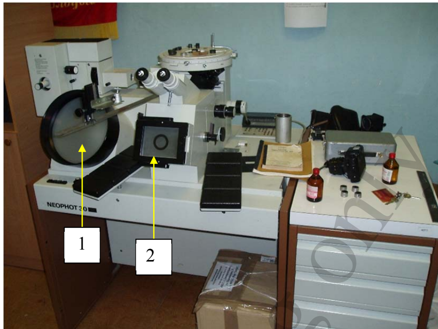
Рис. 2. Оптичний мікроскоп NEOFOT 30: 1 – екран для візуального аналізу, 2 – екран для фотографування
