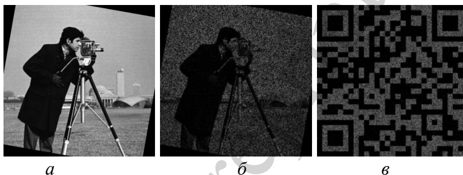
Рис. 22. Компенсація повороту: а - зображення-контейнер; б - виділення цифрового водяного знаку; в - відновлення правильного розташування пікселів у цифровому водяному знаку
