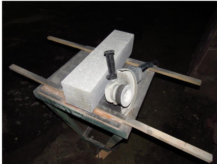
Рис. 3. Вирівнювання поверхні бетону дослідної призми
