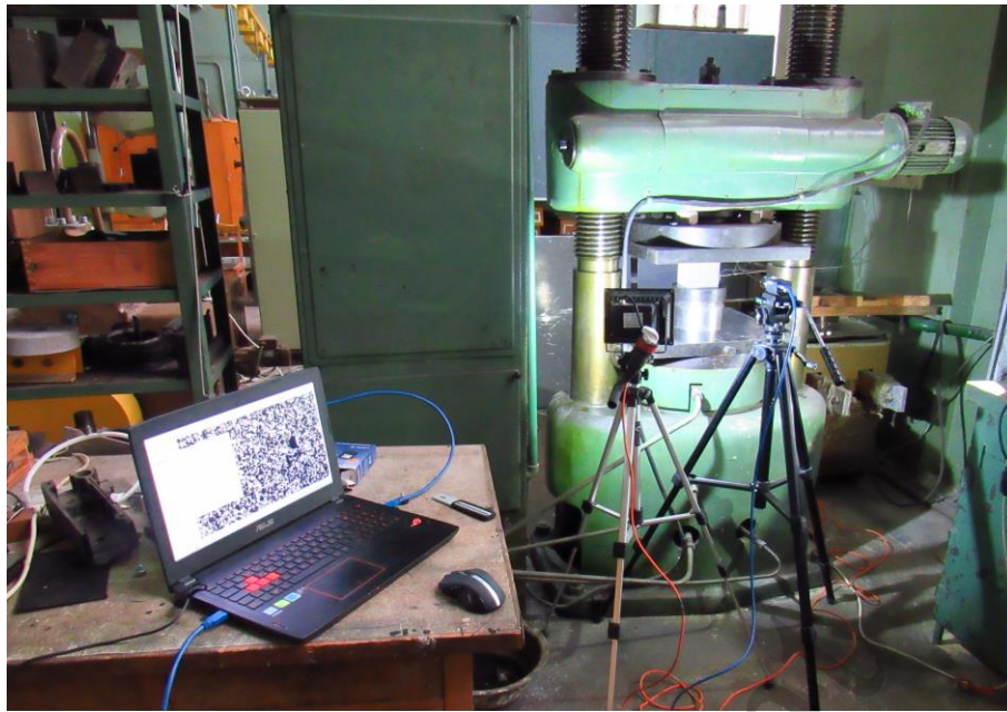
Рис. 7. Загальний вигляд випробування бетонних кубиків 150x150x150 мм
