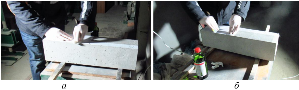
Рис. 5. Створення спектлів на поверхні бетону. а – процес просочування роздрукерованих спектлів на поверхню; б – вирівнювання спектлів на поверхні
