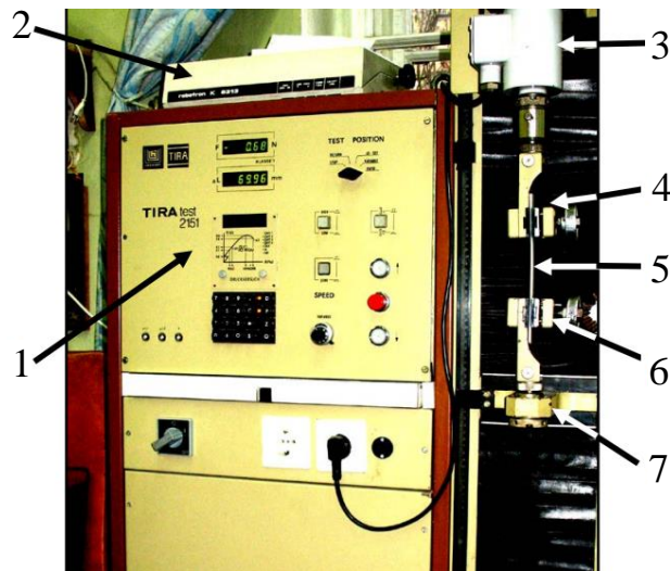
Рис. 2. Загальний вигляд випробувальної машини TIRAtest: 1 – пульт керування; 2 – пристрій для друкування ROBOTRON K6313; 3 – динамометр; 4 – нерухомий (верхній) затискувач; 5 – випробувальний зразок; 6 – рухомий (нижній) затискувач; 7 – рухома траверса
