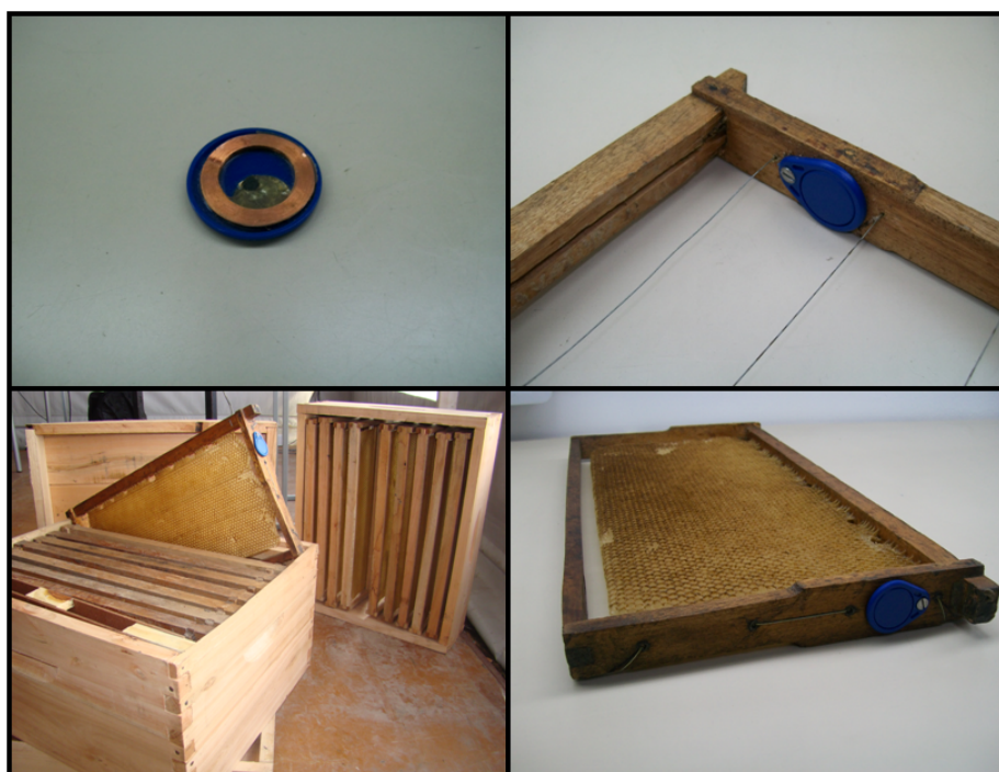
Figura 1. Chip RFID instalado en el Cuadro.
