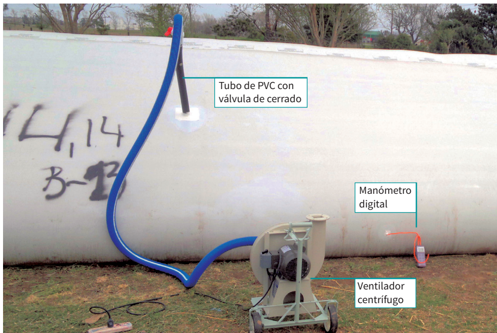
Figura 3. Instrumental usado para realizar el TCP en un silo bolsa de Balcarce.
