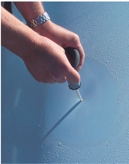
Figura 2. Medición de fosfina en silo bolsa por medio de tubo colorimétrico.
