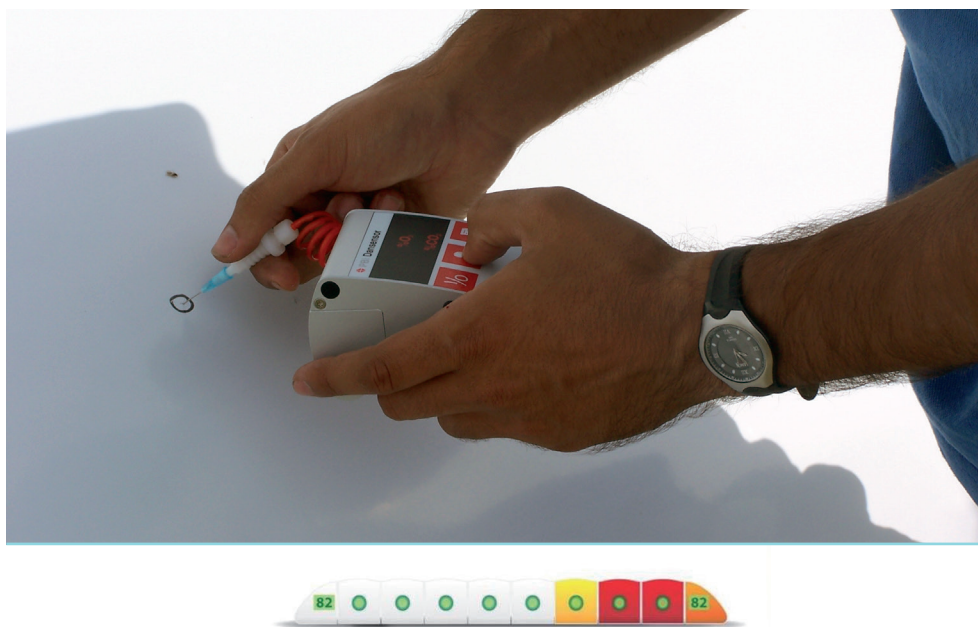
Figura 7. Monitoreo de CO 2 (arriba) y reporte de Internet (abajo) con información visual representado en una escala de colores el índice de riesgo de almacenamiento.
