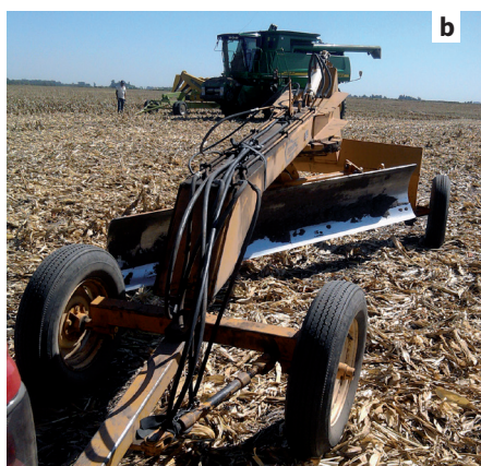
Figura 2. Emplazamiento de bolsas en terrenos con rastrojos. a. Silo bolsa emplazado sobre rastrojo sin alisar. b. Pala para alisado del terreno. c. Silo bolsa emplazado sobre terreno alisado.
