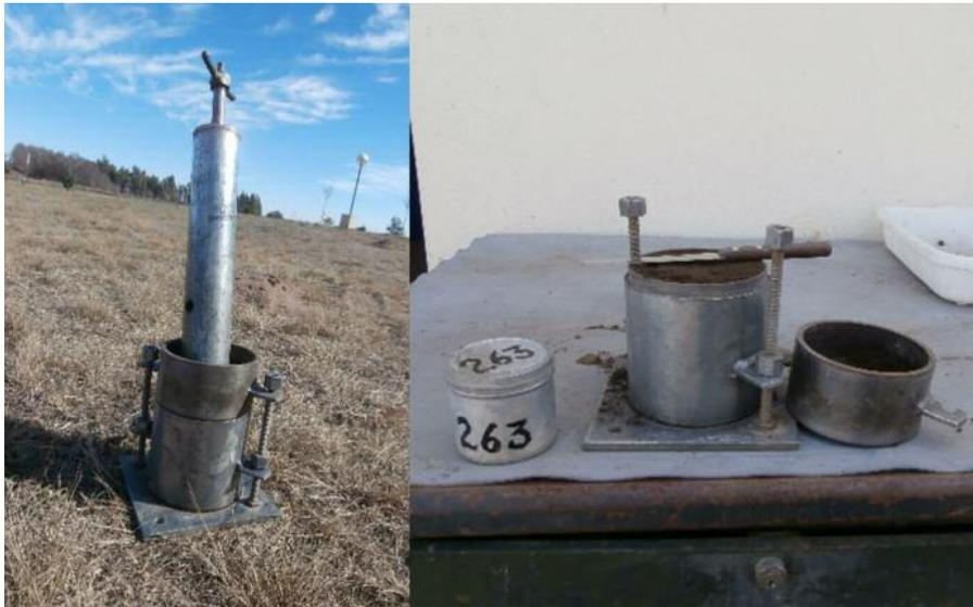
Foto 2: Instrumento utilizado para realizar el test Proctor a fin de determinar parámetros de compactación.
