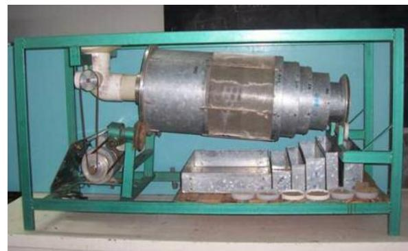
Foto 7: Tamiz rotativo, utilizado para calcular la fracción erosionable.
