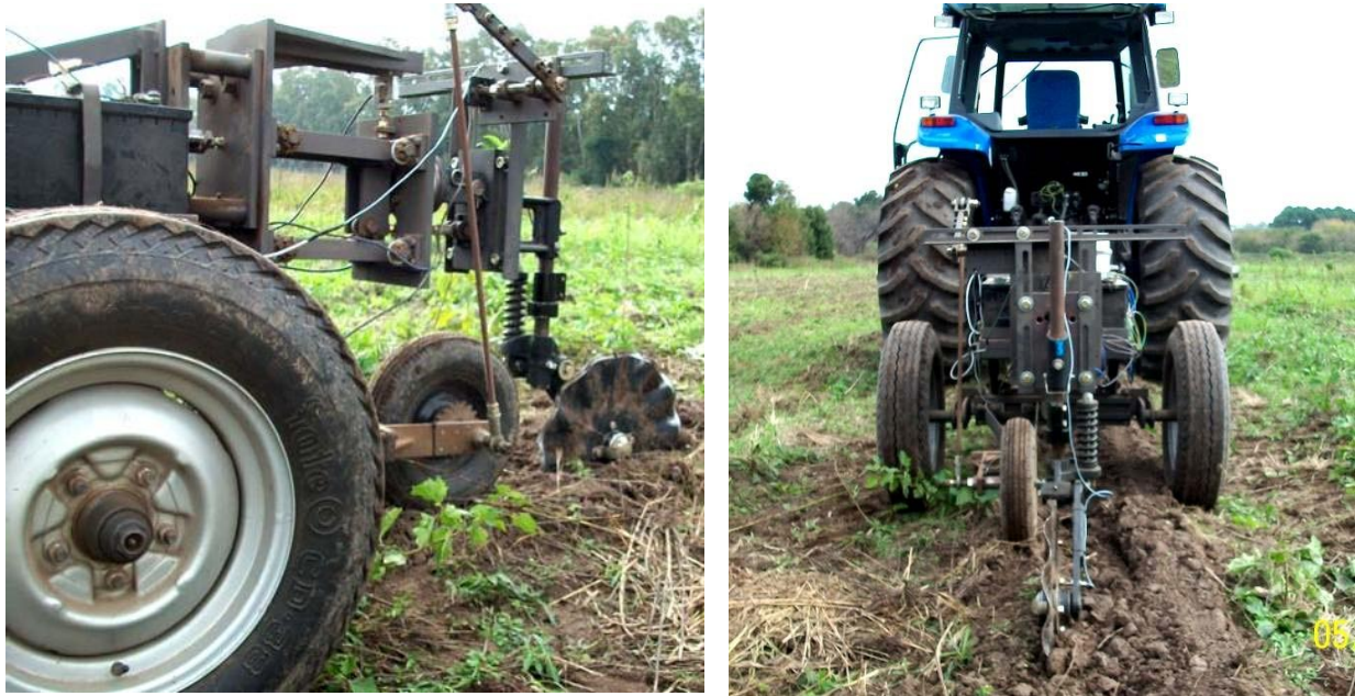
FIGURA 2.1: Izquierda: Vista lateral del carro dinamométrico con la cuchilla en posición de trabajo. Derecha: Vista trasera del equipo completo utilizado en el ensayo.
