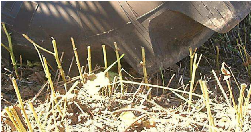
Figura 7. Vista comparativa de la altura de corte de los tallos de 12 cm, respecto de los tacos del rodado delantero de la cosechadora.
