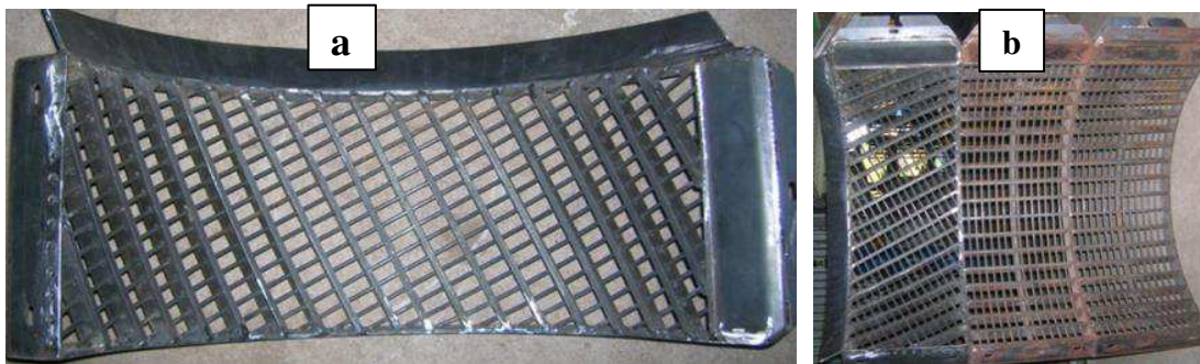
Figura 4. – a Cóncavo de trilla experimental de baja agresividad, con barras oblicuas para granos gruesos. – b Vista del juego de cóncavos experimentales a evaluar.
