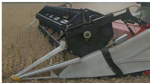
Figura 9. Vista del posicionamiento de las palas del molinete del cabezal draper, respecto de la altura del cultivo.
