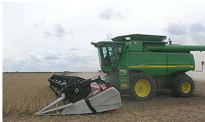
Figura 6. Vista de la cosechadora JD 9760 STS, con el cabezal draper Maizco de 35 pies.
