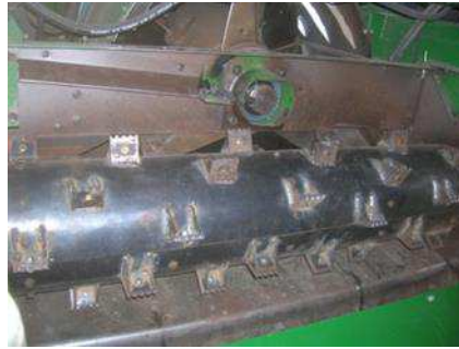
Figura 7. Vista general del rolo acelerador transversal experimental, con disposición helicoidal de sus pletinas, que alimenta al rotor de trilla y separación axial.
