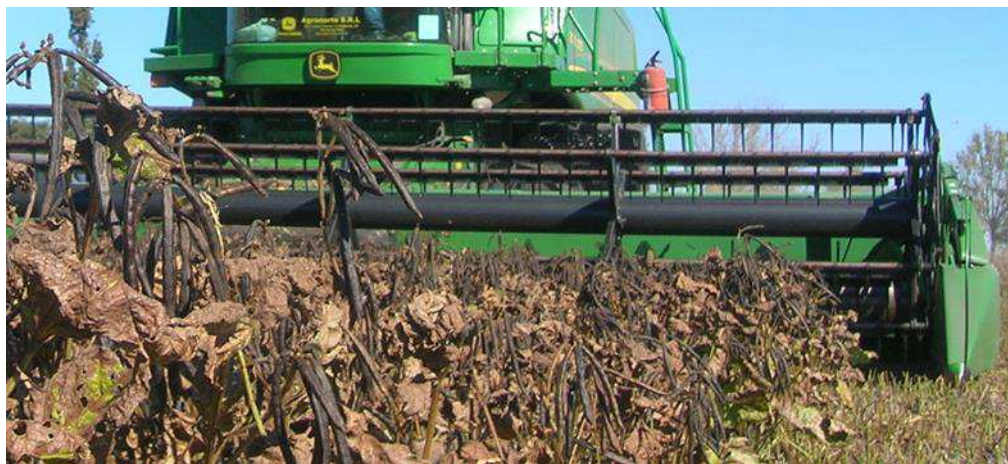
Figura 8. Vista de la posición del molinete unidireccional para barrer la bandeja de captación del cabezal flexible.
