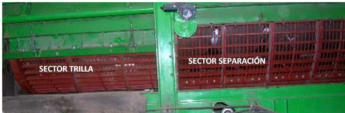
Figura 11. Vista conjunta de los juegos de cóncavos experimentales del sector trilla y de separación.
