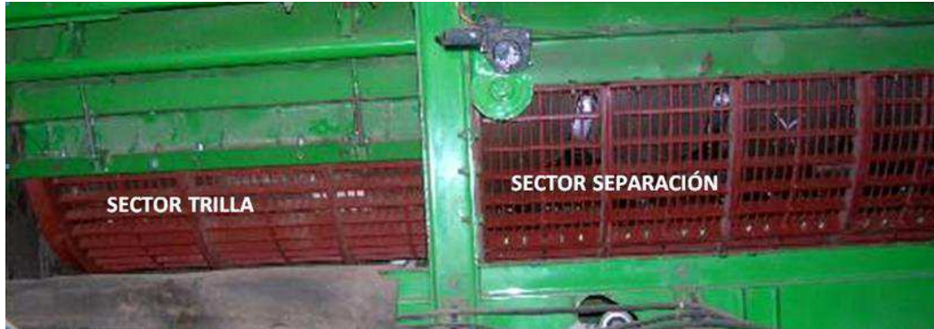
Figura 5. Cóncavos de trilla y separación experimentales, utilizados para el ensayo con la cosechadora JD 9570 STS
