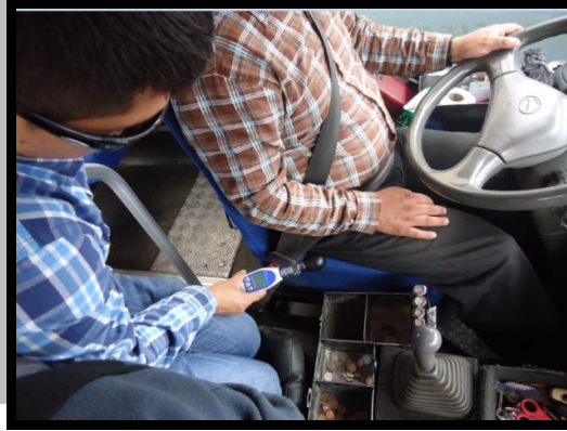
Foto N° 7. Medición WBGT 0,6 m. (2do Conductor).
