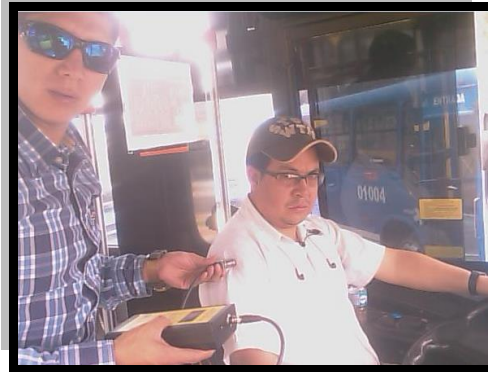
Foto N° 34. Medición Vibración cuerpo entero eje y (3er Conductor).
