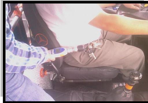
Foto N° 10. Medición WBGT 0,6 m. (3er Conductor).
