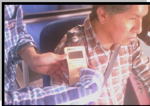
Foto N° 39. Dosis de Ruido (2do Conductor).
