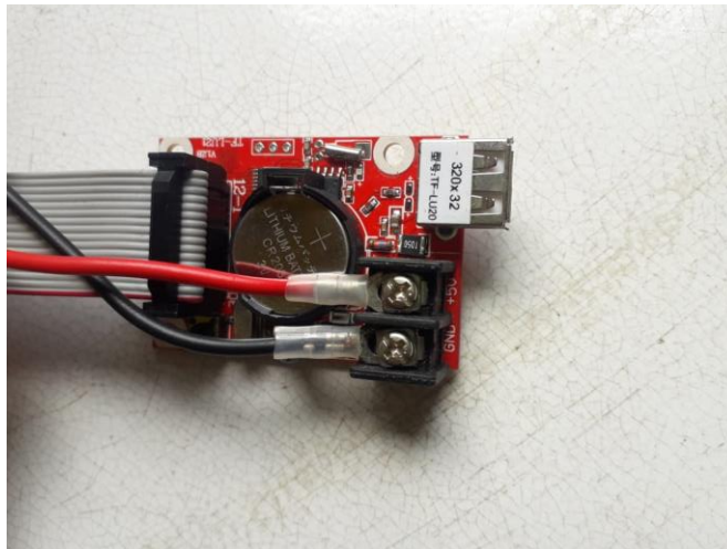
Gambar 3. Pemasangan kabel pada kontroler
