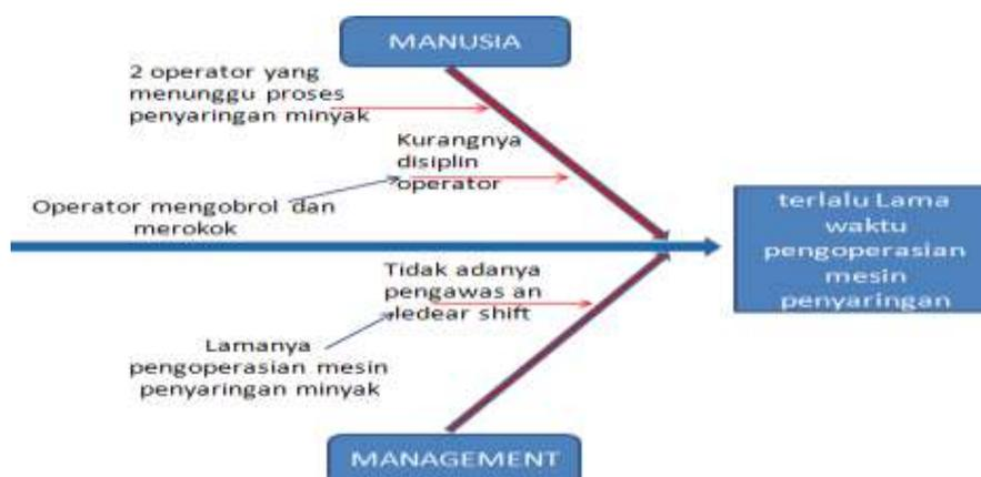
**Gambar 3.** Diagram Sebab Akibat Pada Tahapan Penyaringan Minyak
