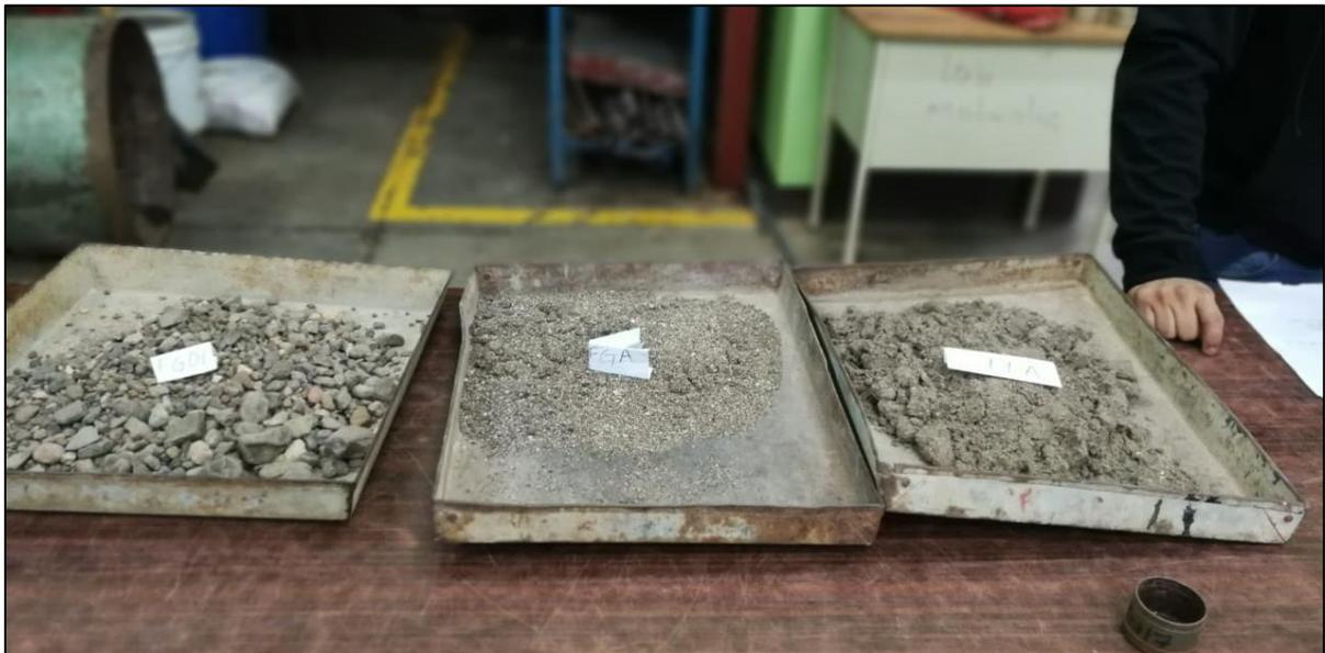
**Figura 56:** Muestras en el laboratorio de la facultad de tecnología en la construcción (FTC) para determinar la granulometría de los lechos filtrantes de cada unidad de tratamiento.
