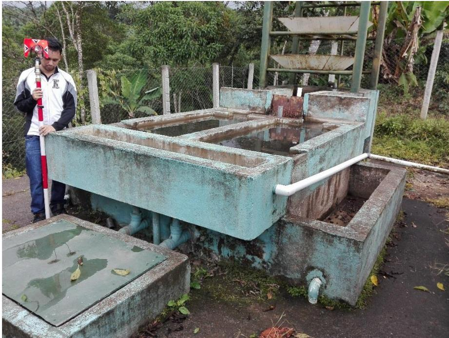
**Figura 60:** Levantamiento de la planta de tratamiento con estación total y prisma en la foto se están determinando las dimensiones del FGDI. Fuente: Autoría propia.
