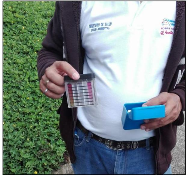
**Figura 37:** En la toma se puede observar el medidor de cloro residual con pastillas DPD1 utilizado en la
