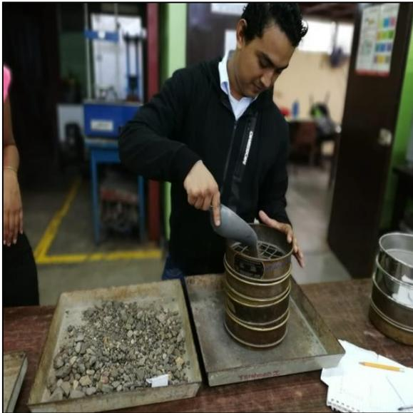
**Figura 57:** Cribado de las muestras de lecho filtrante tomada. Fuente: Autoría propia.
