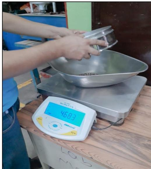
**Figura 59:** Pesaje del material retenido por cada una de las mallas. Fuente: Autoría propia.
