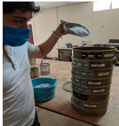
Ilustración 11 – proceso de cada porcentaje retenido de material
