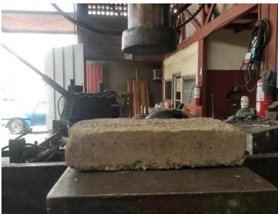
Ilustración 25 - Resistencia a la compresión de ladrillos de mortero y plástico 1:3
