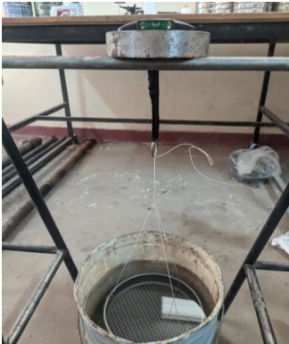
Ilustración 27 – Proceso de elaboración de prueba de absorción.
