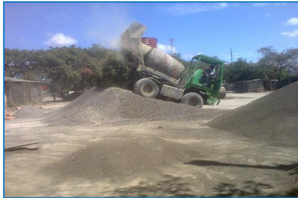
Ilustración N° 9: Mezclador de concreto Merlo recolectando materiales para la mezcla.
