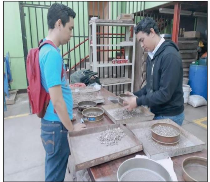
**Figura 58:** Proceso de cribado de muestra de lecho filtrante. Fuente: Autoría propia.
