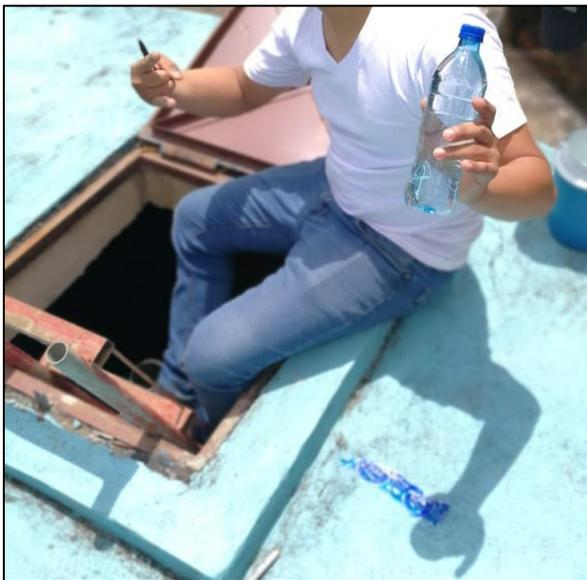
**Figura 52:** Recolección de muestra de agua potable para prueba de turbiedad. Fuente: Autoría propia.
