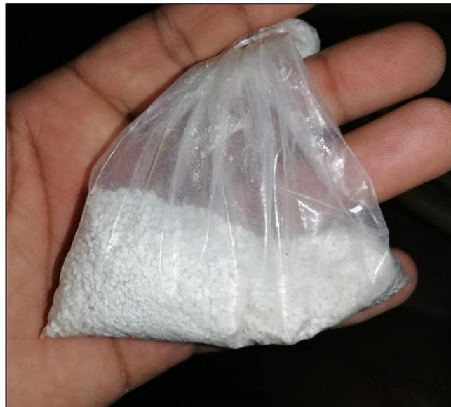
**Figura 38:** Nuevo método de cloración con hipoclorito de calcio en estado granular. Fuente: Autoría propia.
