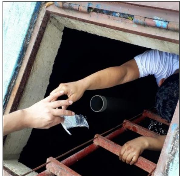
**Figura 53:** Recolección de muestra de agua potable para prueba microbiológica. Fuente: Autoría propia.
