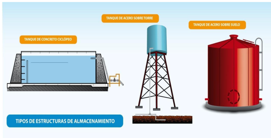
Figura 8: Tipos de estructuras de almacenamiento
