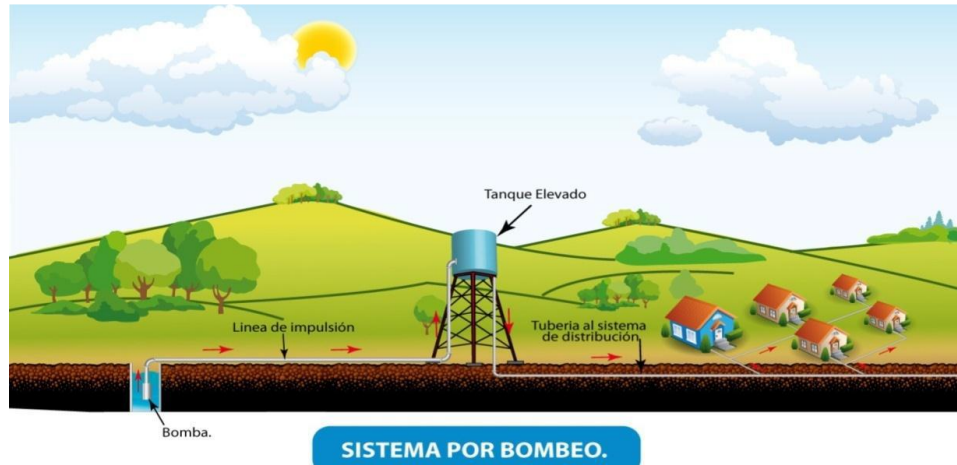
Figura 7: Sistema por bombeo
