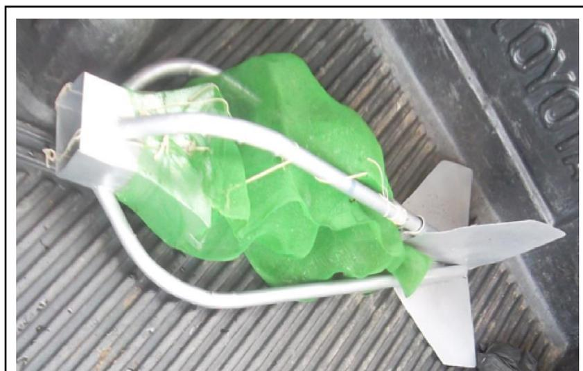
**Figura 12.** Muestreador de Sedimentos Helley – Smith
