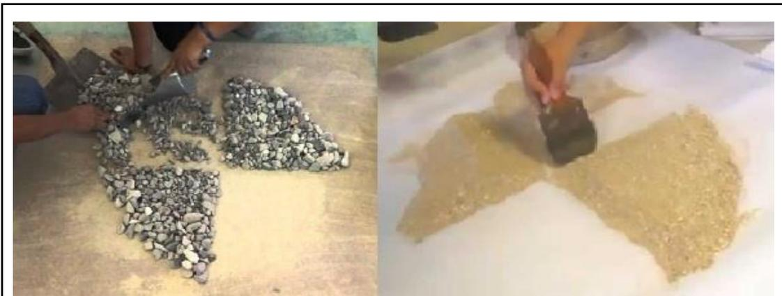
**Figura 41.** Cuarteo de material de agregado grueso y fino para ensayo de granulometría.
