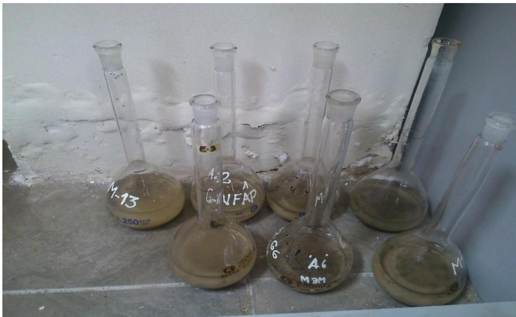
**Figura 43.** Peso específico del agregado fino.
