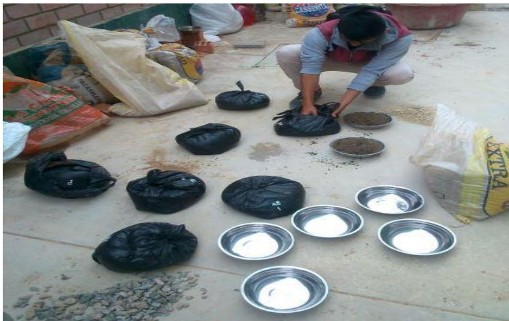
**Figura 45.** Peso específico del agregado grueso.
