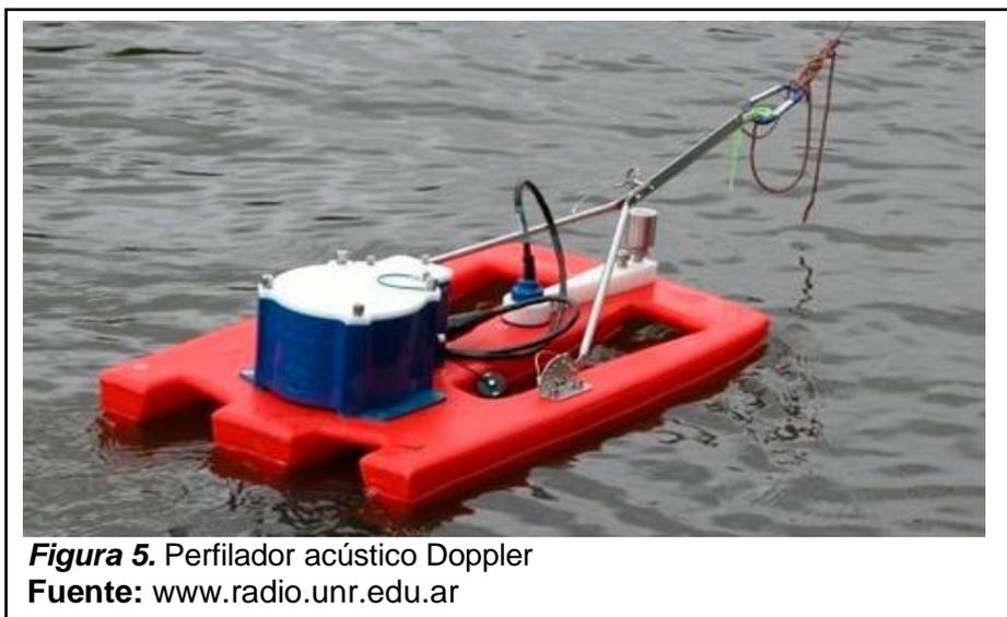
**Figura 5.** Perfilador acústico Doppler
