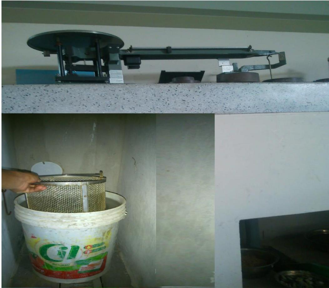
**Figura 44.** Peso específico del agregado grueso.
