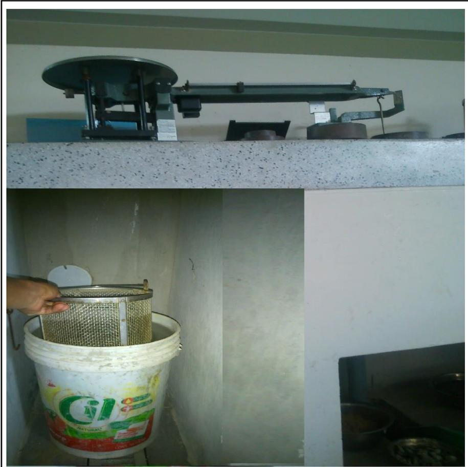
**Figura 24.** Peso sumergido de las partículas de sedimento.
