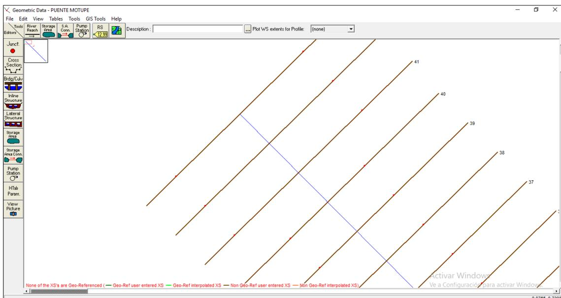
Las características del puente y sus dimensiones serán ingresadas en el programa por medio del comando “bridges and culverts”, teniendo las distancias y cotas reales para mayor precisión.
