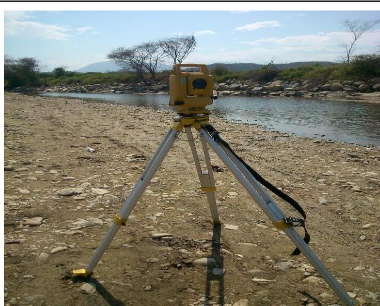
**Figura 26.** Equipo topográfico – Estación Total.
