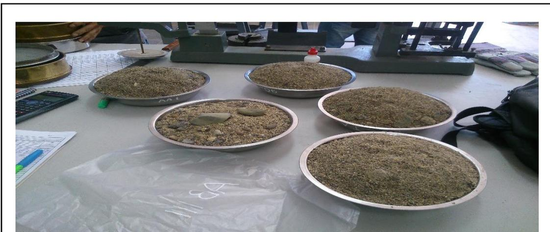
**Figura 42.** Material de agregado grueso y fino en su totalidad para ensayos de granulometría.
