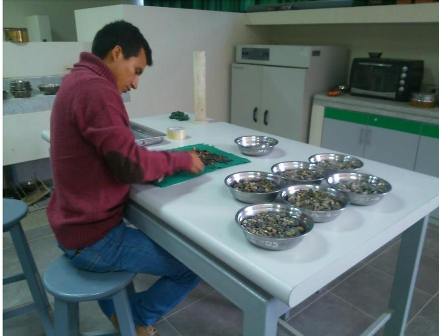
**Figura 22.** Secado de material retenido en la malla N° 200.
