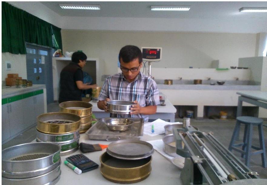
**Figura 21.** Granulometría del material obtenido en campo.
