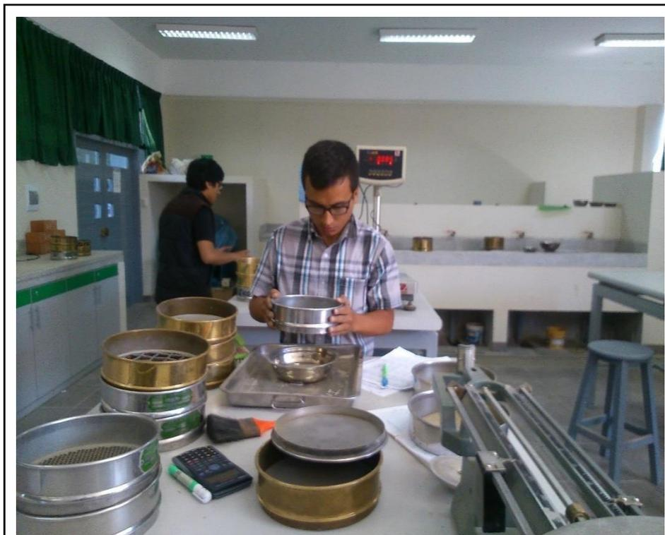
**Figura 28.** Tamizado de las muestras de sedimento.
