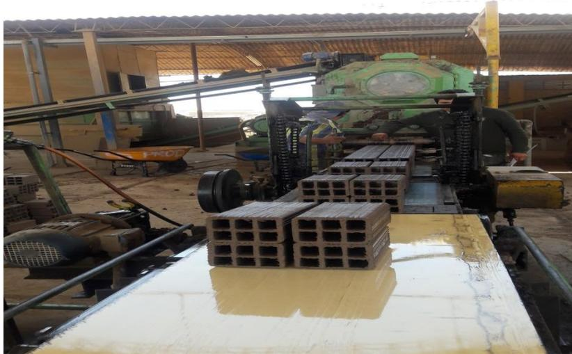
**Figura 27:** Salida del producto en proceso en formado
