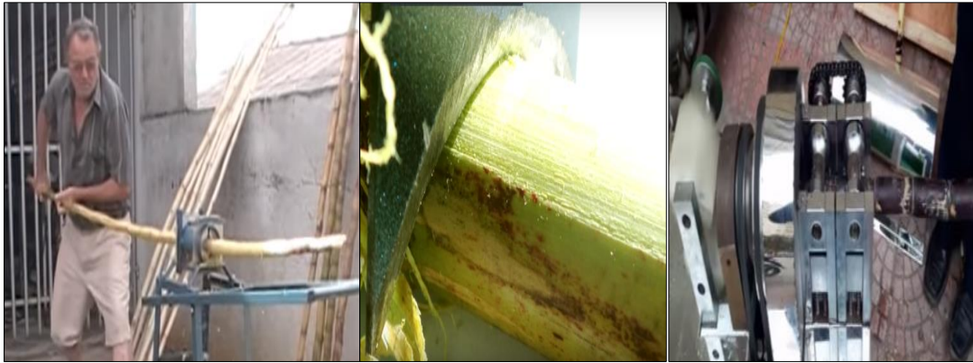
Figura N°17. Máquina de pelar caña de azúcar tipo comercial Máquina de pelar caña de azúcar tipo comercial.
