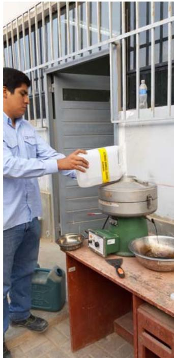
Fotografía 9: Ensayo de lavado asfáltico.
