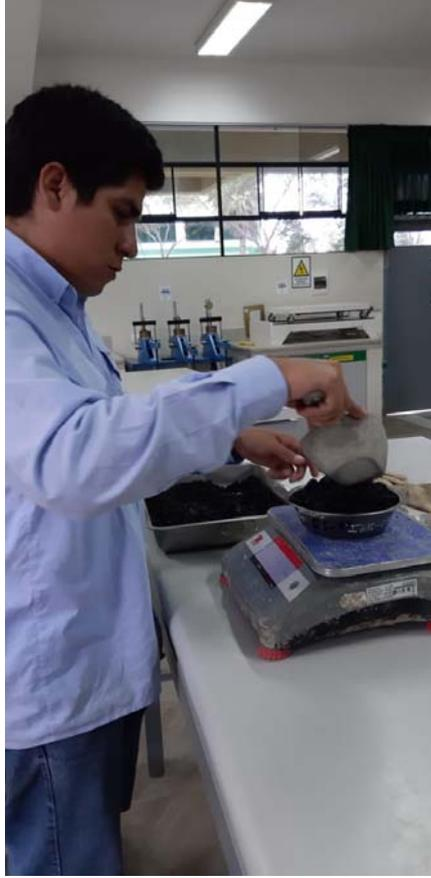
Fotografía 7: Selección de material para posteriormente realizar el ensayo de lavado asfáltico.
