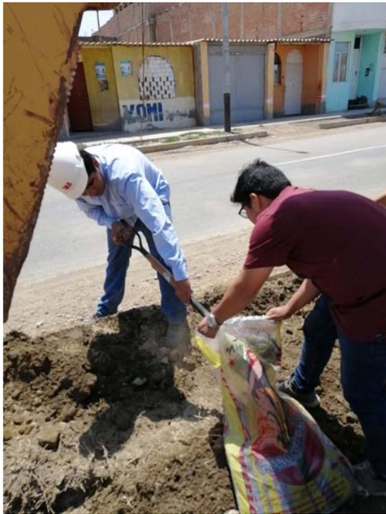
Fotografía 3: Extracción de muestras de suelo para ensayos en laboratorio.
