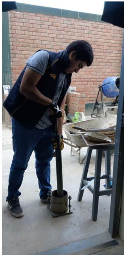
Fotografía 6: Ensayo de CBR.
