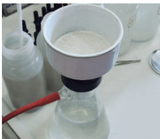
Figura 50. Filtración utilizando embudos Buchner para obtención de extracto saturado.
