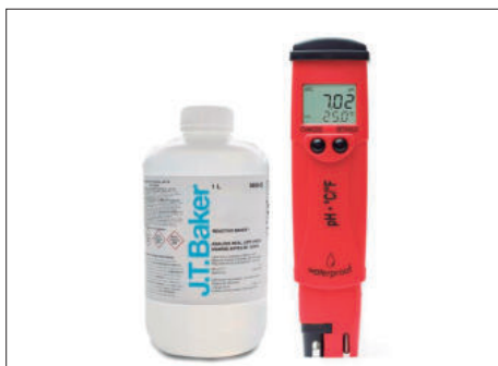
Figura 40. pHmetro y la solución a calibrar a un pH 7.
