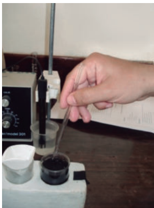
Figura 55. Uso de papel filtro para medición de conductividad eléctrica en suelo.
