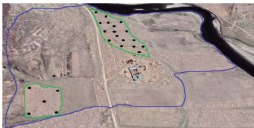
Figura 9. Identificación de puntos de muestreo, empleando el método de zigzag y el método en X.
