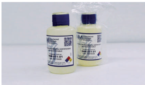
Figura 36. Materiales de referencia para calibración de instrumentos.
