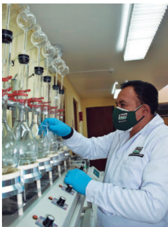
Figura 39. Uso del material de referencia secundario en medición de la concentración de K.
