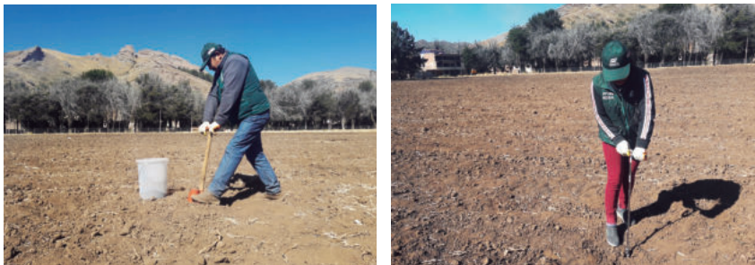
Figura 11. Toma de muestra con dos tipos de barreno.
