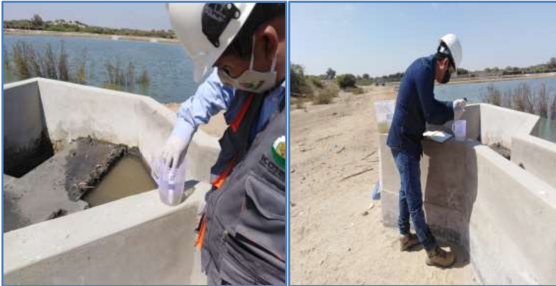
Figura N° 14: Medición insitu de agua residual PTAR “El Indio”
