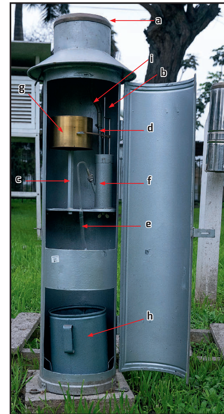
FIGURA N° 2.2 Partes del pluviógrafo
