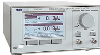
Figura 3.10: Medidor de potencia doble canal.
