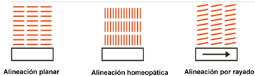
Figura 1.11: Tipos de alineación para un cristal líquido nemático (CLN).
