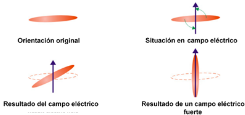
Figura 1.9: Resultado de la orientación de las moléculas de un cristal líquido bajo la influencia de un campo eléctrico.
