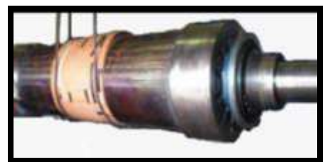
Gambar 2. Rotor Tipe Silinder Untuk Generator Sinkron 3000 Rpm
