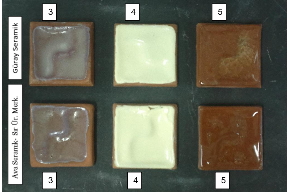
Şekil 12. İki farklı bünye üzerine uygulanarak sinterlenen sırlı numuneler.
